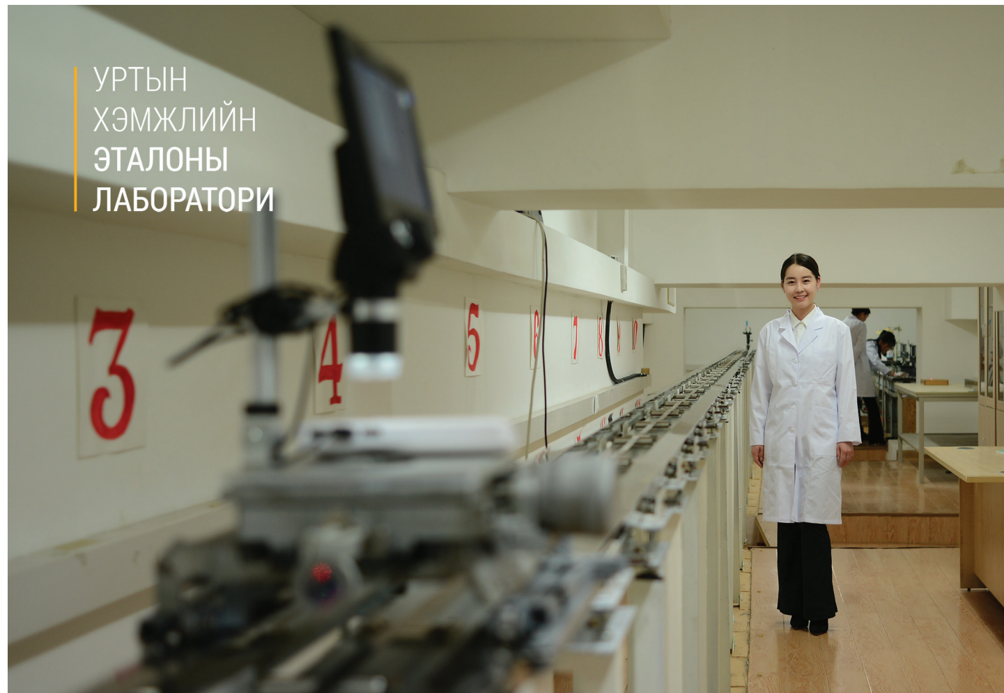
Уртын хэмжлийн анхдагч эталон | Иодоор тогтворжуулсан 633 нм долгионы урттай Гелий Неон лазер үүсгэгч
